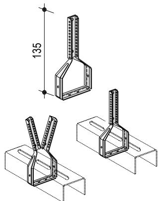
Обогните нониус-хомут вокруг профиля UA 50/40 и установите его, пока он не защелкнется. Применяется для крепления каркаса подвесного потолка из профилей UA 50/40 и ПП 60/27 к несущему основанию. Крепление нониус-подвеса к несущему основанию выполняется при помощи верхней части нониус-подвеса фиксаторами.
