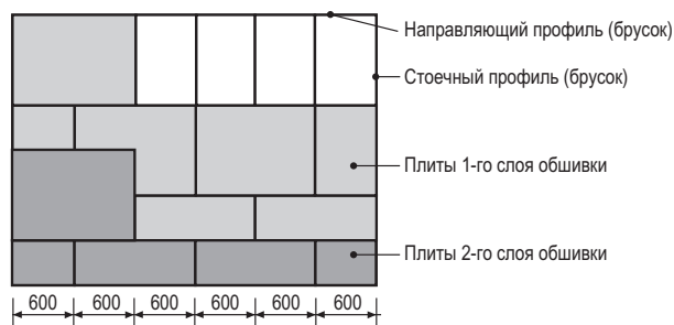
Рис. 2. Крепление плит при двухслойной обшивке
